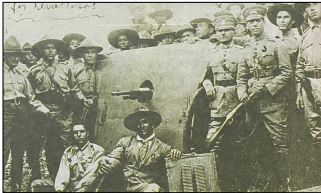
Hotchkiss M1914, com proteção frontal e rodado, para acompanhar a cavalaria. Notar que o militar da arma de cavalaria está portando uma clavina Winchester calibre .44, orgânica a esta arma. Na outra foto, uma Madsen ao centro e outros militares portando clavinas Winchester.
