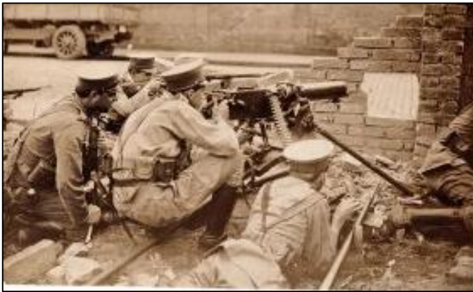
Nestas fotografias vê-se a metralhadora Maxim-Vicker Mkl, conhecida como a Rainha da Morte. Calibre 7,7mm (.303), podia dar 450 tiros por minuto. Seu cinto de munição carregava 250 projeteis. Tinha um alcance de 700 metros. Fonte: Hemeroteca do autor.
