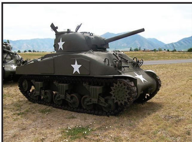
Os Sherman iniciais dispunham de blindagem e armamento inadequados para enfrentar os tanques alemães.
