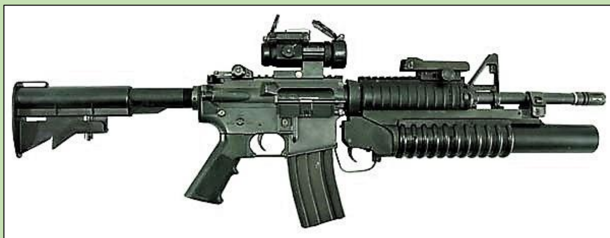
Carabina Colt M4A1, calibre 5,56X45 mm NATO, c/visor Aimpoint M68, apontador laser NA/PEQ-4 e lançador de granadas M-203 calibre 40X46 mm.
