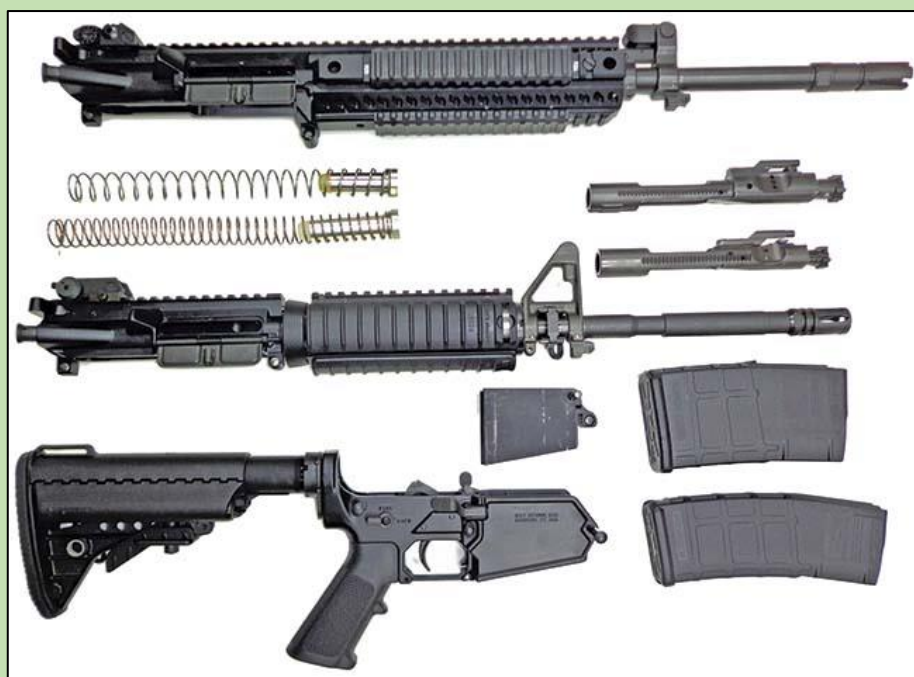
Fuzil Colt CM901 Modular, calibres 7,62X51 mm NATO e 5,56X45 mm NATO. Disponível também em 7,62X39 M43 e 6,8 mm SPC.
