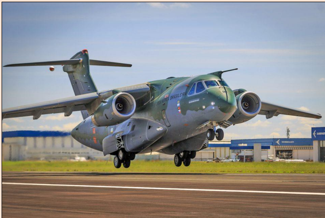
O KC-390 é projetado para transportar até 26 toneladas de carga, capacidade superior a do Hercules (FAB)
