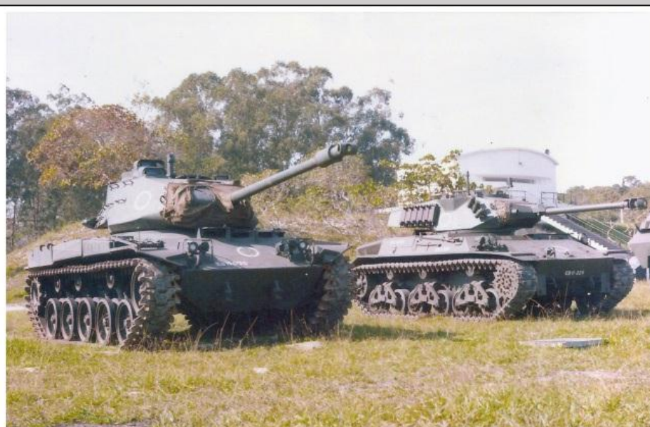
Figura 2: Carro de Combate M-41B, à esquerda e Carro de Combate X1-A2 com torre nacional e canhão francês de 90 mm à direita, em 1978.
