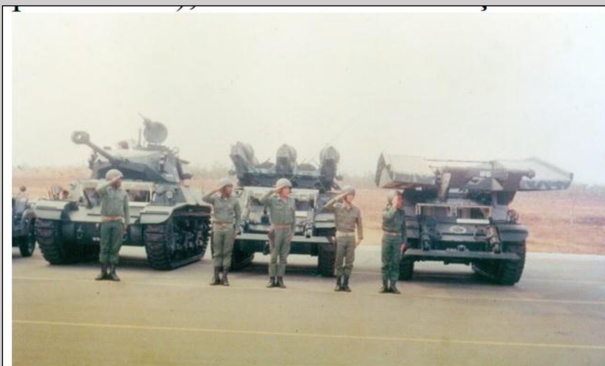
Figura 1: Família X-1. Da esquerda para a direita, protótipo do Carro de Combate X1A1 Carcará; Carro Lançador de Foguetes XLF-40 e Carro Lança Ponte XLP-10 treinando para o desfile de 7 de Setembro de 1976.
