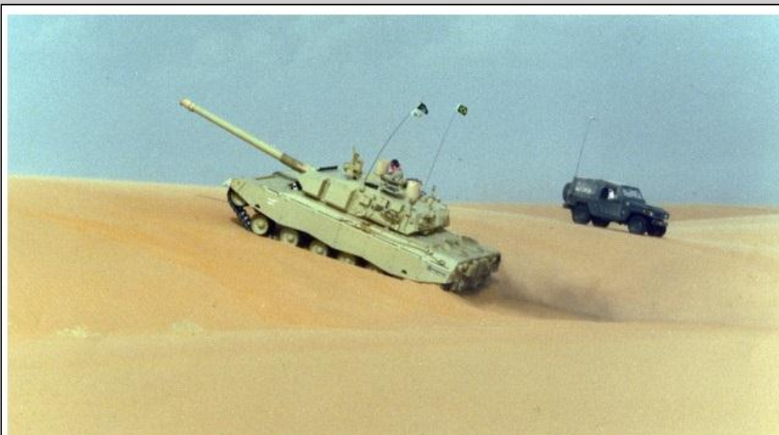
Figura 8: Protótipo P2 do EE-T1 Osório realizando testes na região de Sharourah, na Arábia Saudita, em 1987, com canhão GIAT 120 mm, onde participou de uma concorrência ao lado dos carros de combate M-1 Abrams (USA), AMX-40 (França) e Challenger (Inglês), surpreendendo.
