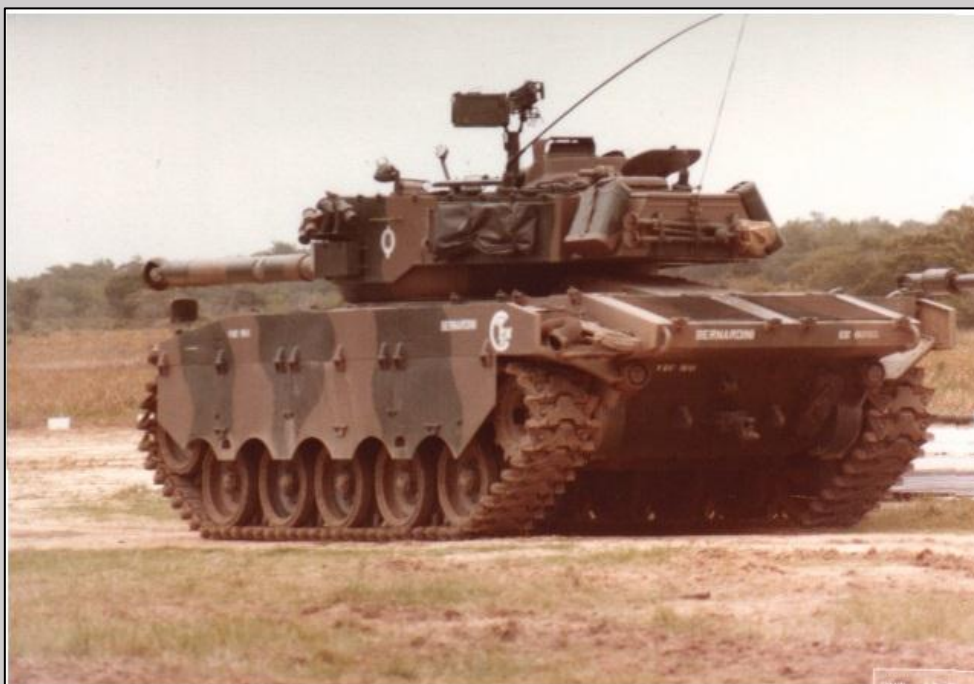
Figura 4: Versão final do que deveria ter sido o M-41C modernizado pela Bernardini. Notar as saias laterais e canhão francês Super 90 capaz de disparar a munição cônica dummy 90 mm F4 que nunca foram aplicadas aos veículos de série, em outubro de 1985. Este canhão foi usado num dos protótipos do MB-3 Tamoyo I.
