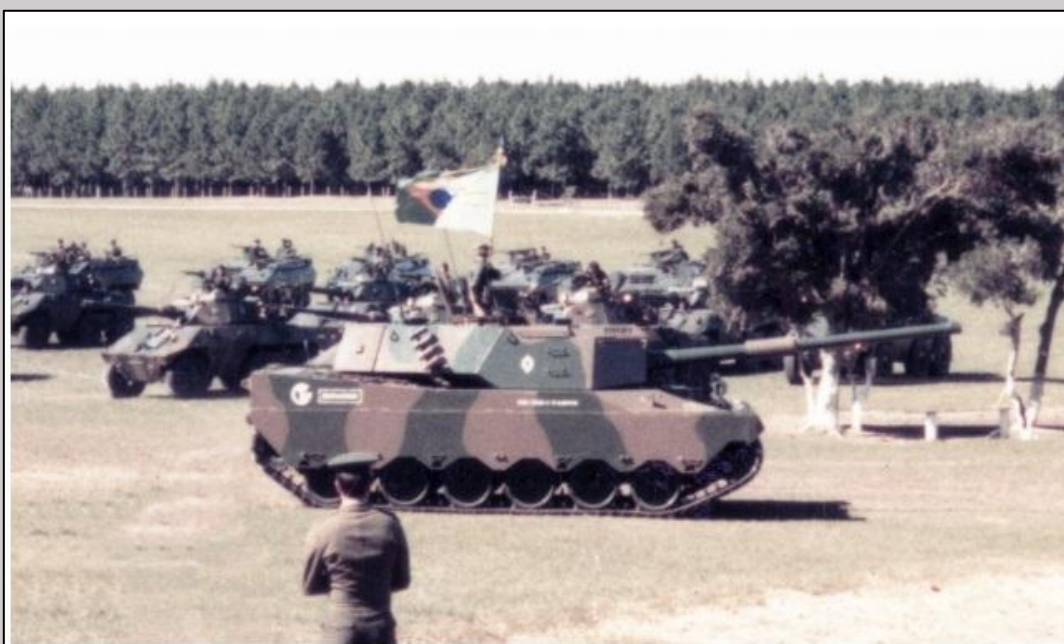
Figura 5: Tamoyo III, com canhão L7 A3 de 105 mm, com a torre redesenhada e construída em aço e material composto, na Festa da Cavalaria, no Rio Grande do Sul, em 10 de Maio de 1987.
