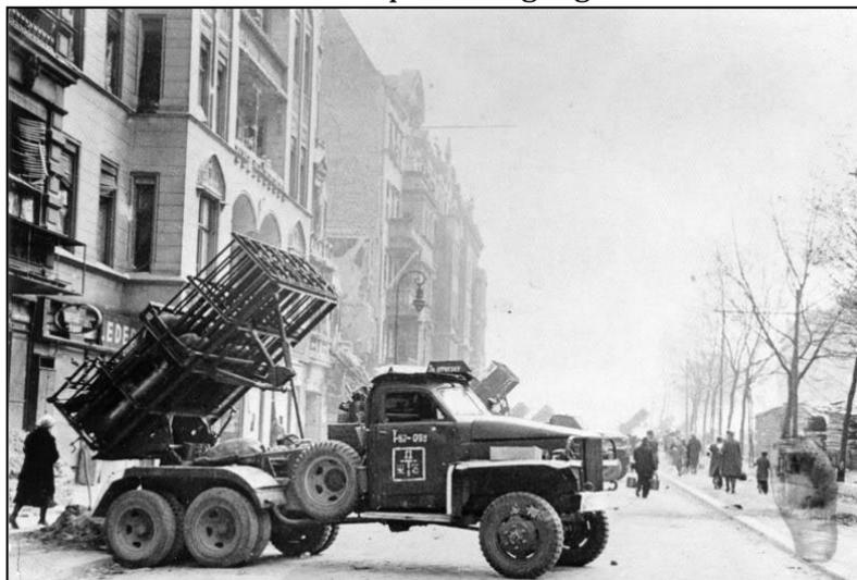
*Figura 4: Caminhão 6x6 de fabricação americana utilizado pelos soviéticos como lançador de foguetes de saturação Katyusha.*
